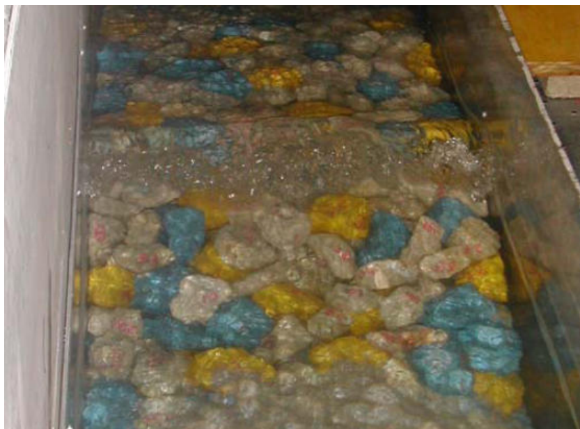
Riproduzione sperimentale del comportamento idrodinamico di un'opera di difesa costiera del tipo sommerso.
