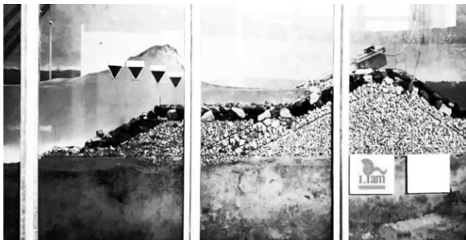
2. Prove sperimentali relative a un'opera a gettata con berma sommersa all'interno del Llam dell'Università dell'Aquila
